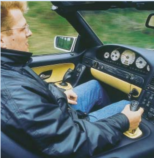
Im Versuchsfahrzeug nachgewiesen: Mit Sidesticks kann der Fahrer in kritischen Situationen schneller reagieren als mit Gas- und Bremspedal.
