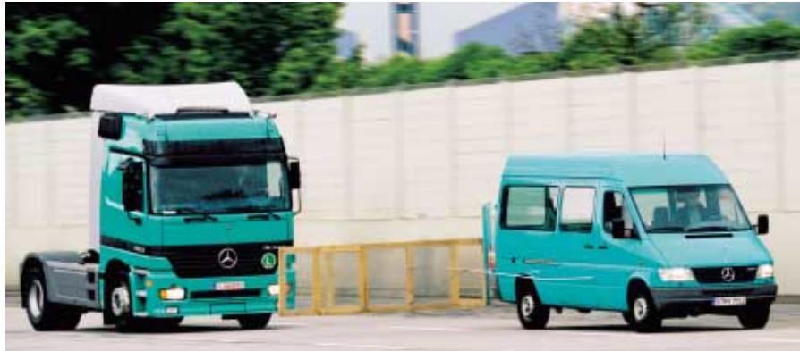
Das automatische Notbremssystem PROTECTOR warnt den Fahrer vor einem drohenden Auffahrunfall zunächst akustisch und optisch. Reagiert er nicht, bremst das System den Lkw mit maximaler Verzögerung ab.
