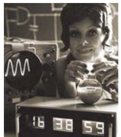
Erfindung der verdrehten nematischen Zelle (TN-Zelle, James Ferguson, Martin Schadt und Werner Helfrich) – hier als Anwendung eine 1972 bei Merck konstruierte Digitaluhr mit „flüssigen Zahlen“.
